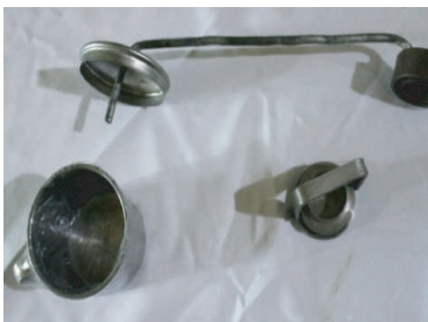
Image 10 : La lanterne à cornue/Lanterna Retors pour limiter la quantité du mercure
